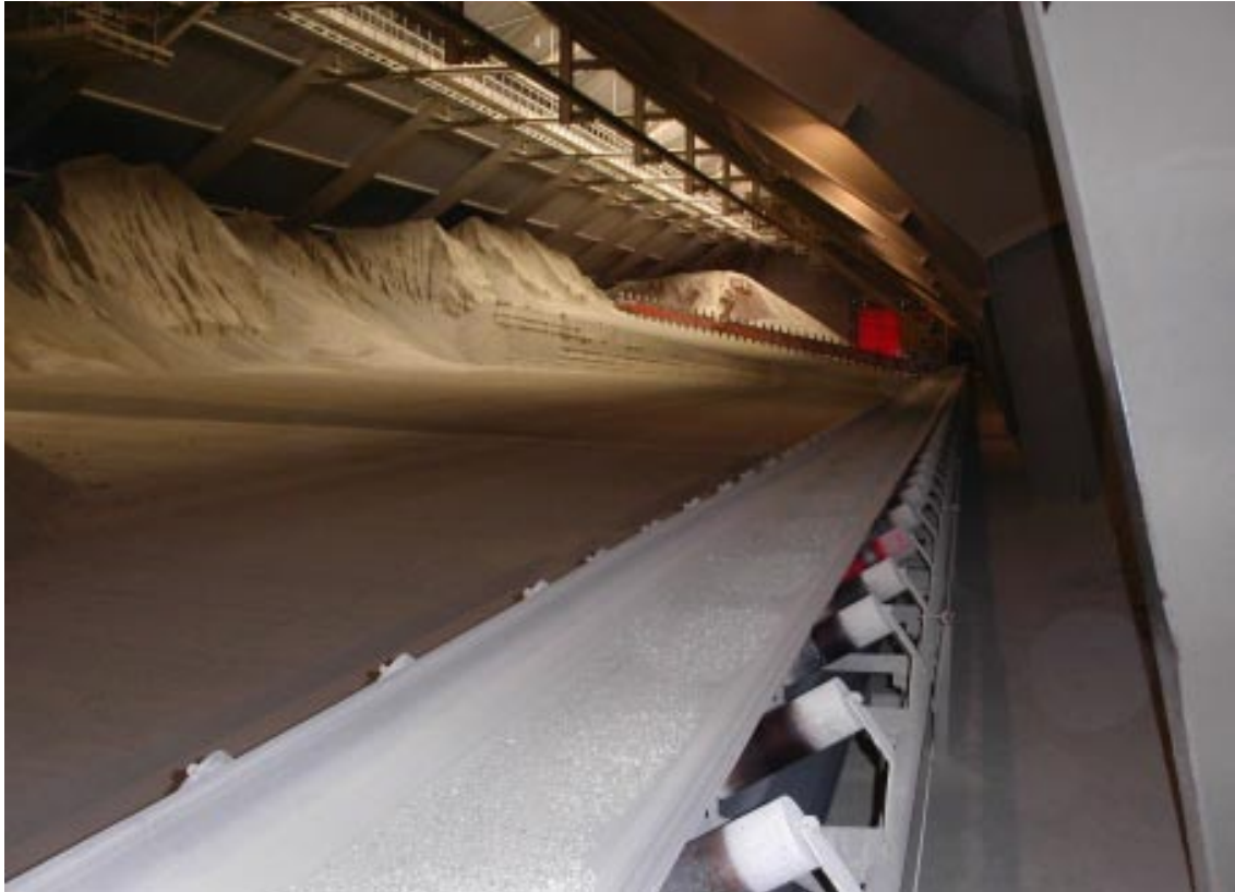
Figur 3-6. Exempel på automatisk utlastning från bentonitlager.
