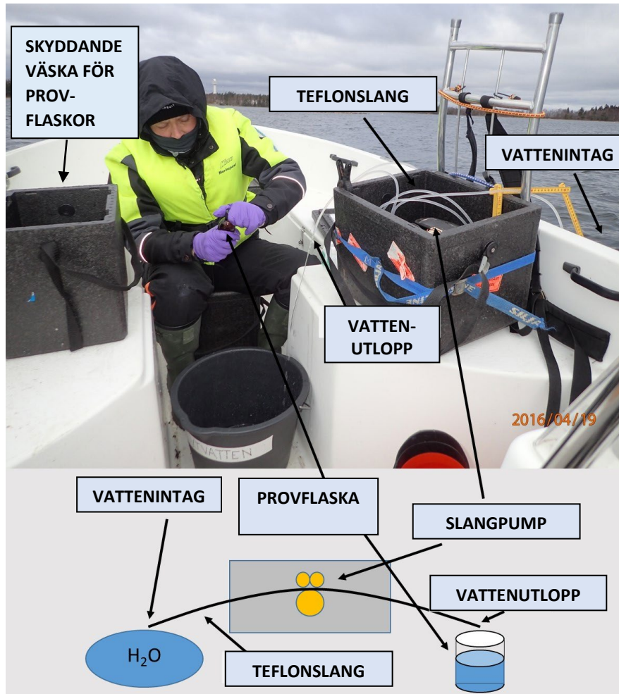
Figur 3-4. Vårprovtagning av ytvatten med slangpump på en havspunkt. Under fotografiet visas en schematisk bild av pumpenheten.
