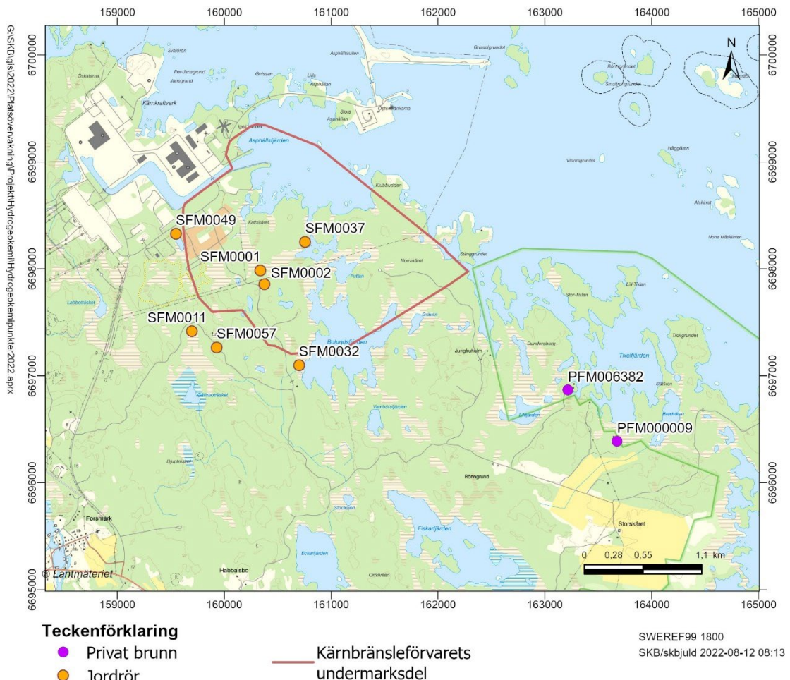
Figur 2-1. De sju jordrören och de två brunnarnas placering i undersökningsområdet samt i förhållande till det planerade kärnbränsleförevarets undermarksdell.
