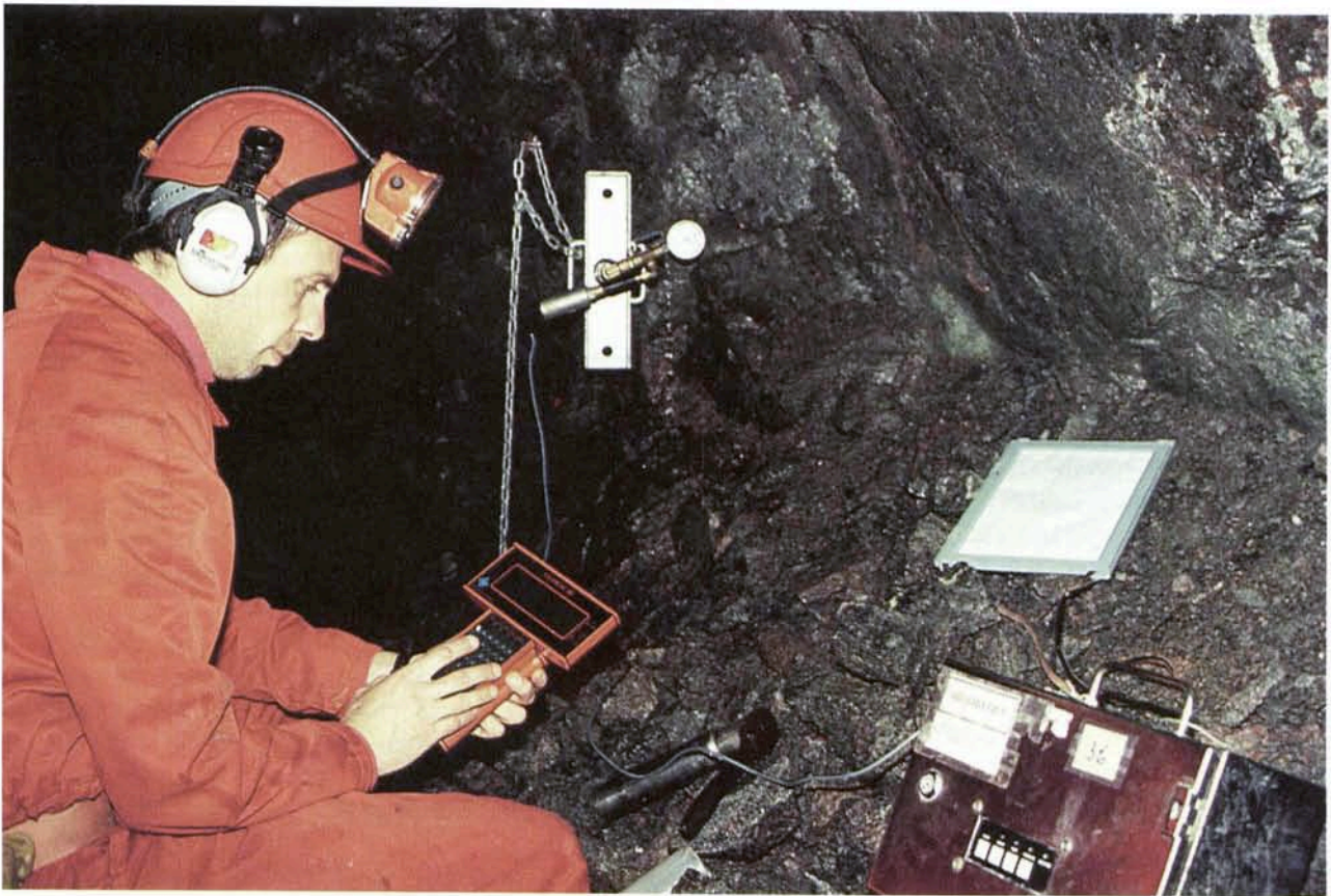
Figur 12-5. Var fjärde "salva" borrar två 20 m långa undersökningshål framför tunneln. Tryckuppbyggnadstest genomförs för att mäta vattengenomsläppligheten (transmissiviteten).
