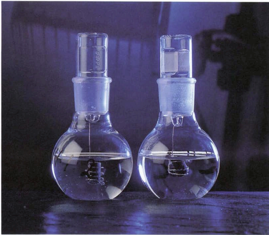
Figur 11-1. Försöksupställning för lakning av använt bränsle under oxiderande förhållanden.
