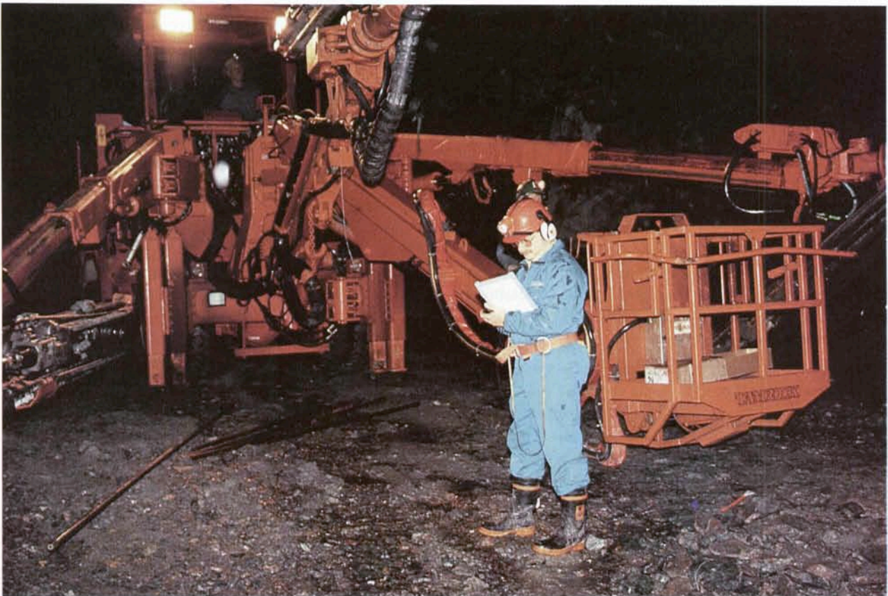
Figur 12-4. Varje "salva" dokumenteras enligt /12-10/. Resultaten jämförs sedan med de prediktioner av berggrunden som redovisats i /12-6/.
